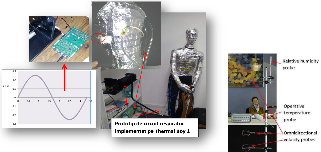
Figura 3: a) Implementarea unui circuit respirator pe primul prototip Thermal Boy 1, b) Sistem standardizat [6] de evaluare a confortului termic (cu sondă omni directională de viteză, sondă de temperatura operativă și umiditate relativă) [7]
